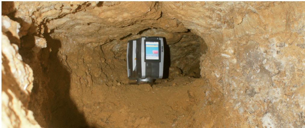
Gracias al reducido tamaño del FARO Focus 3D se pueden capturar datos en sitios muy inaccesibles.
